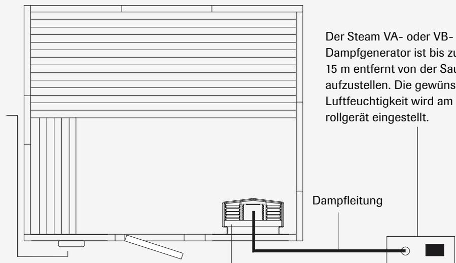
Der Steam VA- oder VB-Dampfgenerator ist bis zu 15 m entfernt von der Sauna aufzustellen. Die gewünschte Luftfeuchtigkeit wird am Kontrollgerät eingestellt.
