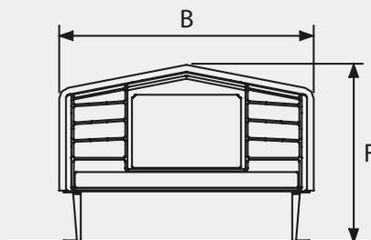
Wird an der Wand in 270 mm Höhe über dem Boden bis zur Unterkante des Saunaofens montiert (Compact und Combi 4 170 mm).
