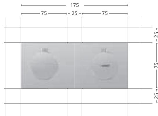
Das konsequente Rastermaß von 25 mm liegt jeder **HANSAMATRIX**-Planung zugrunde, schafft größtmöglichen gestalterischen Spielraum und bietet gleichzeitig maximale Sicherheit. Auch die Formen der **HANSAMATRIX**-Komponenten basieren auf dem 25-mm-Raster.
