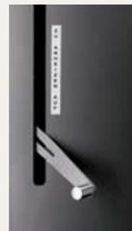
Um nach dem Anheizen möglichst schnell die optimale Brennraumtemperatur zu erreichen, wird die Anheizklappe geöffnet. Die Abgase strömen ohne großen Widerstand an dem Wärmetauscher vorbei. Dadurch entsteht ein höherer Zug und somit eine stärkere Sauerstoffzufuhr. Wenn nach einigen Minuten die Anheizklappe wieder geschlossen wird, entfaltet sich der volle Wirkungsgrad des Kaminofens.
